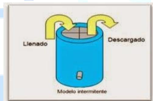
Figura 27. Biodigestor de flujo discontinuo
