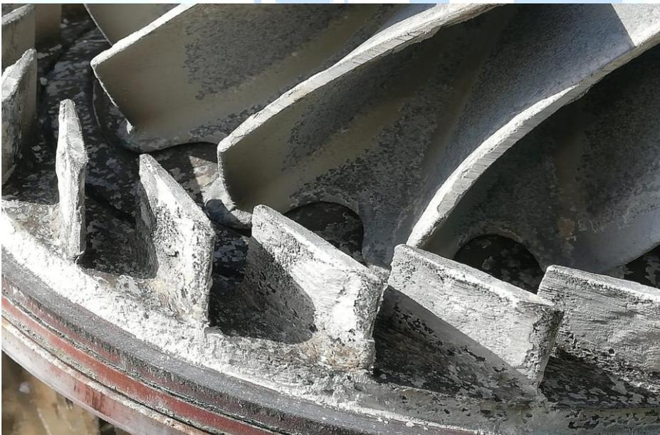
*Figura 46. Hélice deteriorada por la sílice, ampliación de la Figura 34, El Gorguel (Cartagena, Murcia)*
