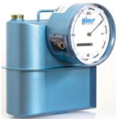
Por ejemplo, los medidores de gas de fuelles (Figura 21) son muy empleados cuando se quiere tomar medidas del volumen de los gases inertes y secos, además de ser realmente eficaces cuando se quieren evaluar flujos altos de gas, (siempre y cuando no sean superiores a 500 mbar de presión). (“Medidores de volumen de gas - MK Energía,” n.d.)
