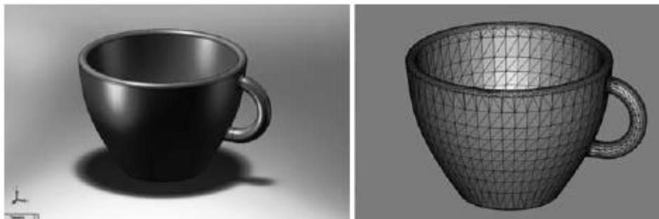
Figura 2.2. Conversión de modelo CAD a formato STL
