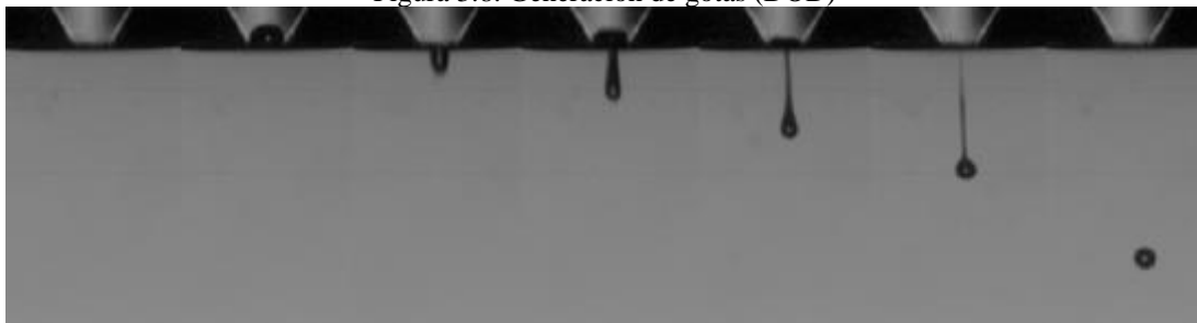
Figura 3.8. Generación de gotas (DOD)
