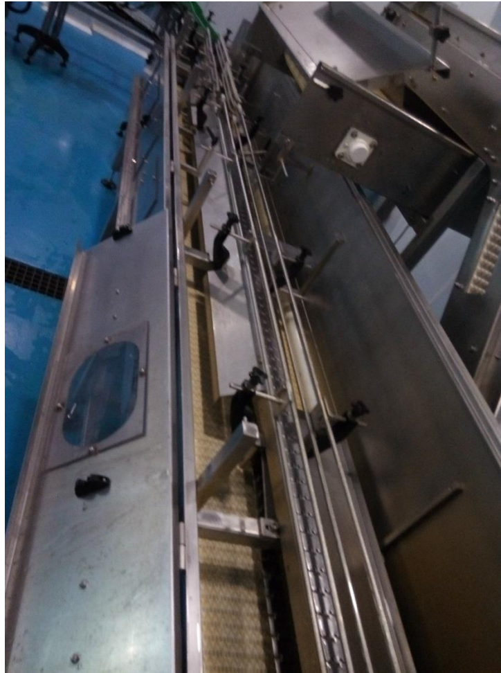
13. Cinta de transporte de tarros y cinta de recogida de sobrante.
