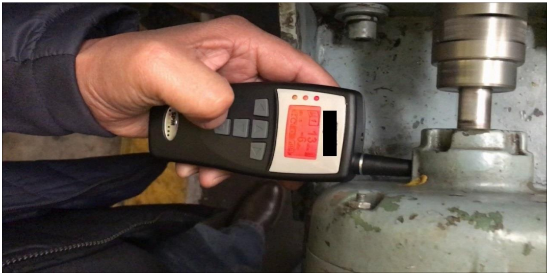
41. Medidor de impulsos de choque.
