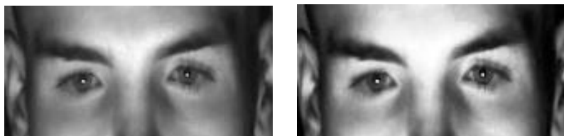
Ilustración 33. Imagen antes y después del proceso de ecualización de histograma en imagen con una iluminación no uniforme.
