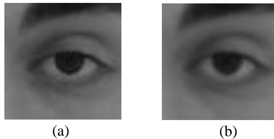
Ilustración 54. (a) Imagen de entrada al sistema, (b) imagen filtrada con núcleo gaussiano 3x3
