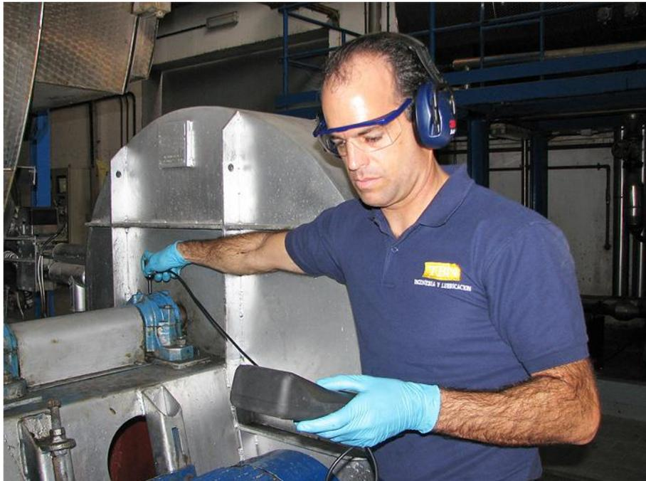
Figura 23. Medición de Spike Energy.
