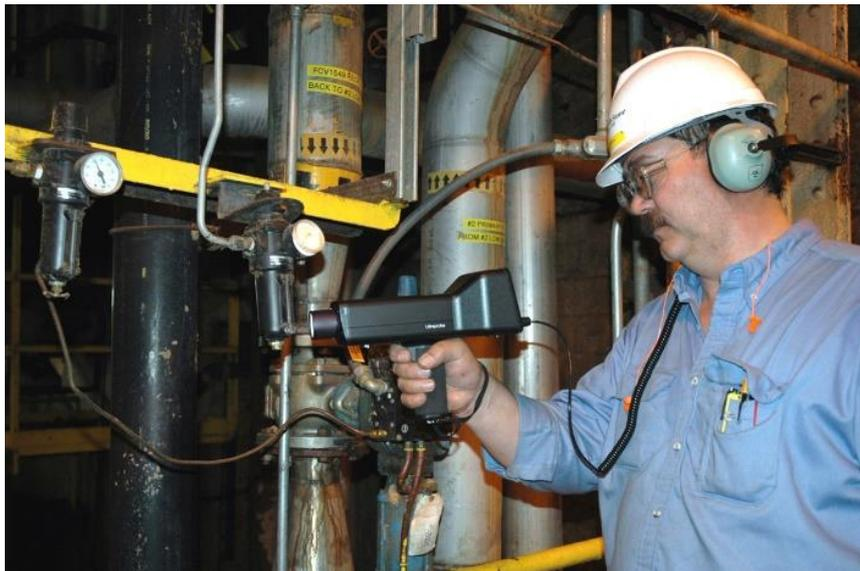
Figura 24. Detección de fugas mediante ultrasonidos.
