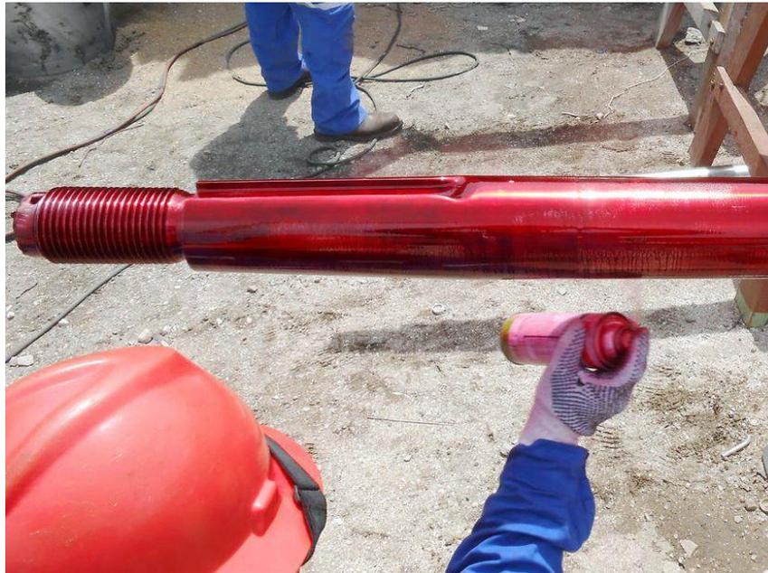
Figura 29. Aplicación de líquidos penetrantes.
