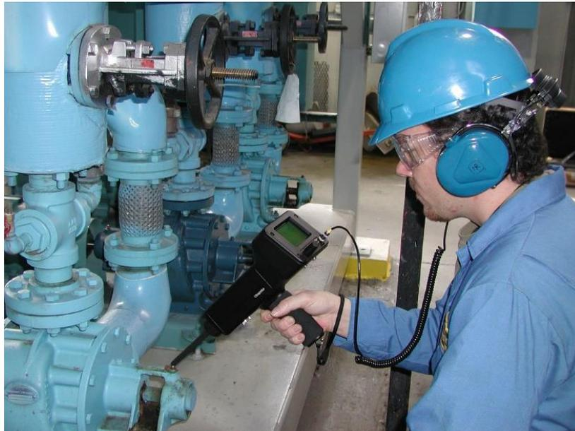
Figura 26. Inspección de rodamientos mediante ultrasonidos.
