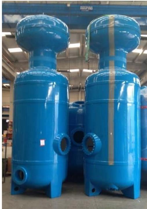
Figura 8. Disolvedores de CO<sub>2</sub> a baja presión.
