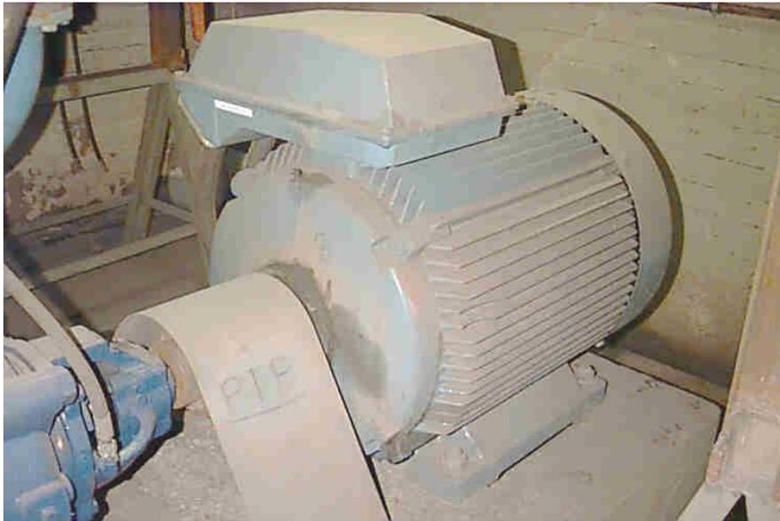
Figura 39. Imagen real de un motor eléctrico con rodamientos sobrecalentados.
