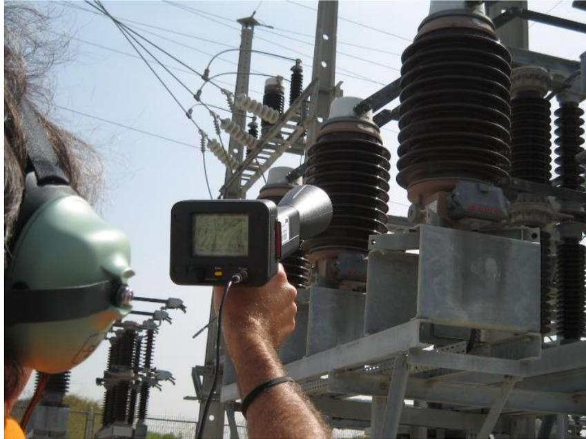
Figura 25. Medición de fenómenos eléctricos mediante ultrasonidos.
