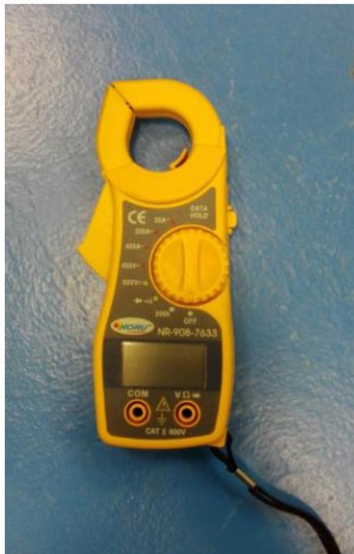
**Figura 45: Pinza amperimétrica**
