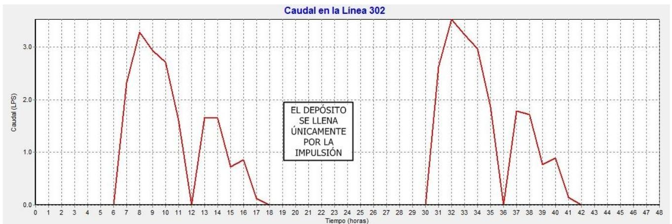
Figura 3.18. Caudal de salida del depósito semienterrado (A2)
