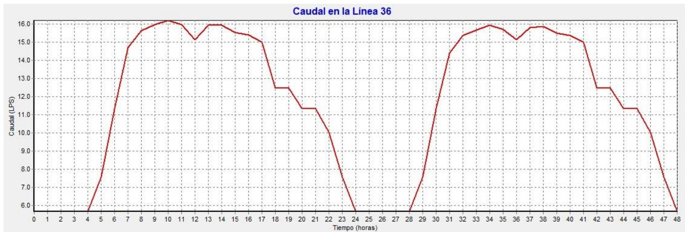
Figura 3.22. Caudal de salida del depósito elevado de  $100\text{ m}^3$  (A2)
