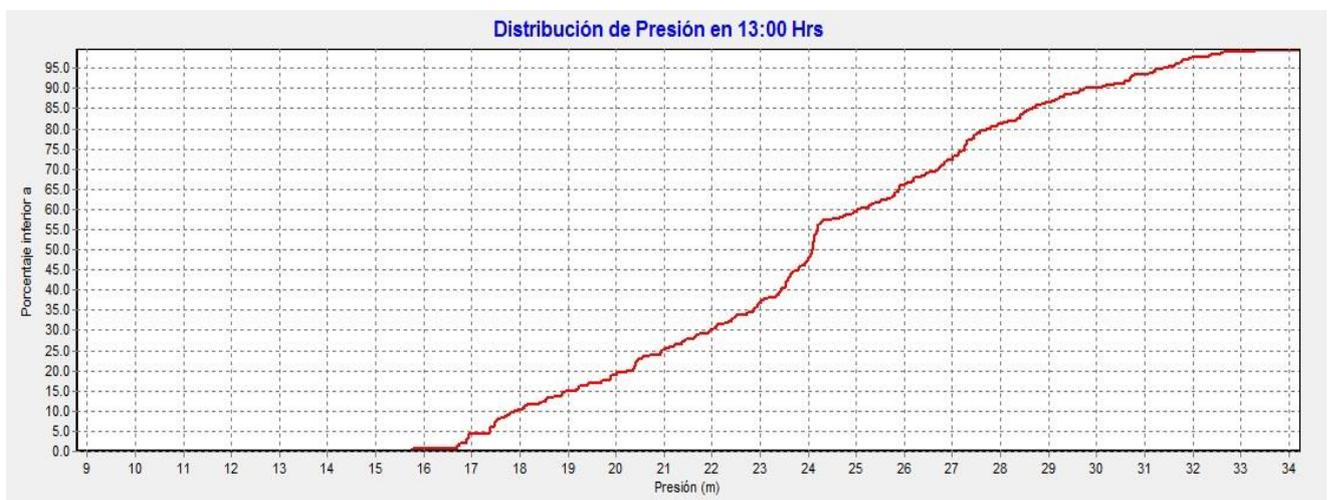
Figura 4.15. Distribución de presiones en los nodos de la red de Cholqui a las 13:00 H
