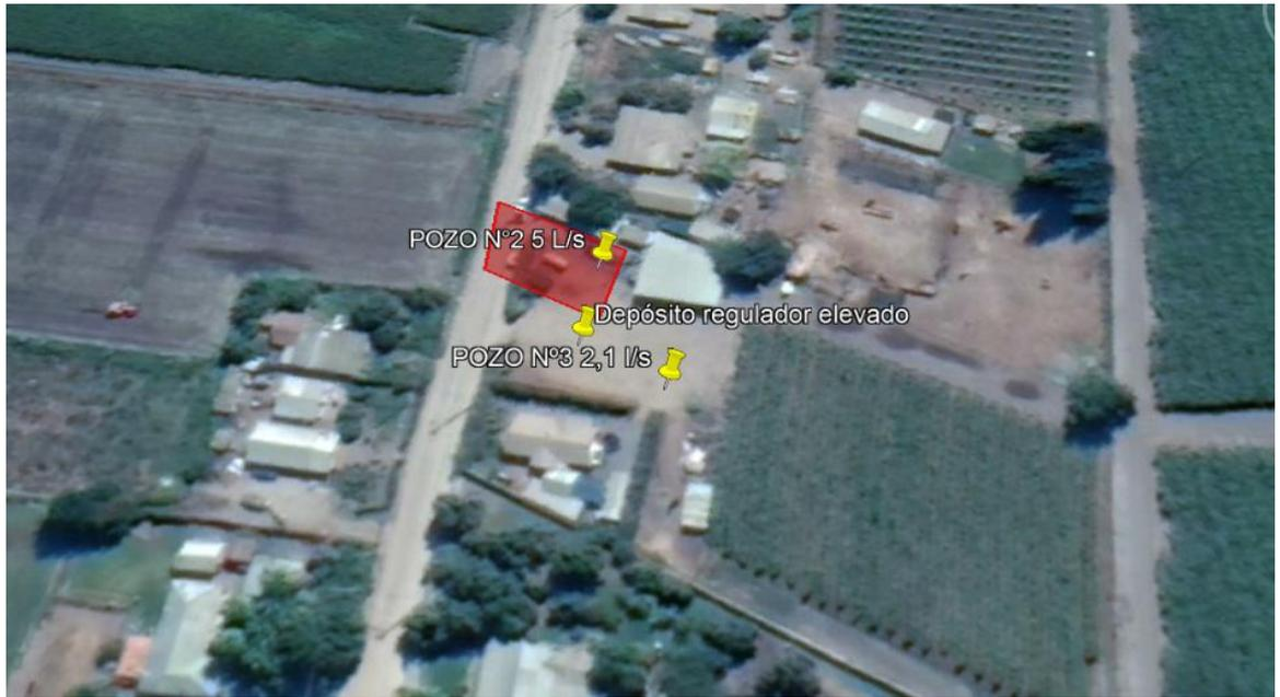
Figura 3.12. Mapa de ubicación del depósito de regulación proyectado
