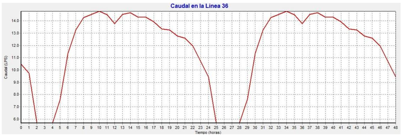
Figura 3.10. Caudal de salida del depósito elevado de 100 m<sup>3</sup> (A1)
