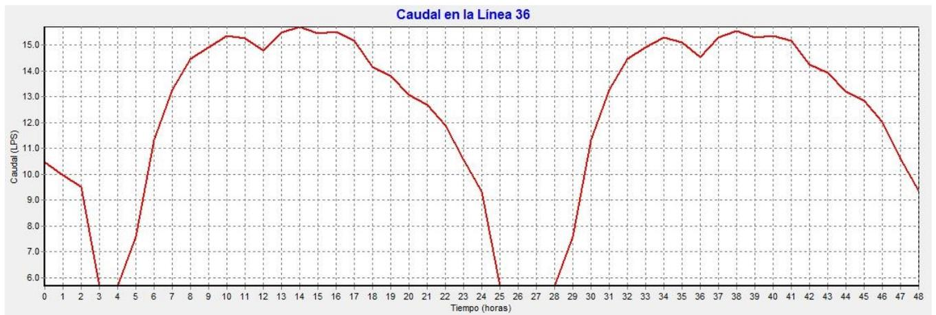
Figura 3.29. Caudal de salida del depósito elevado de  $100 \text{ m}^3$  (A3)
