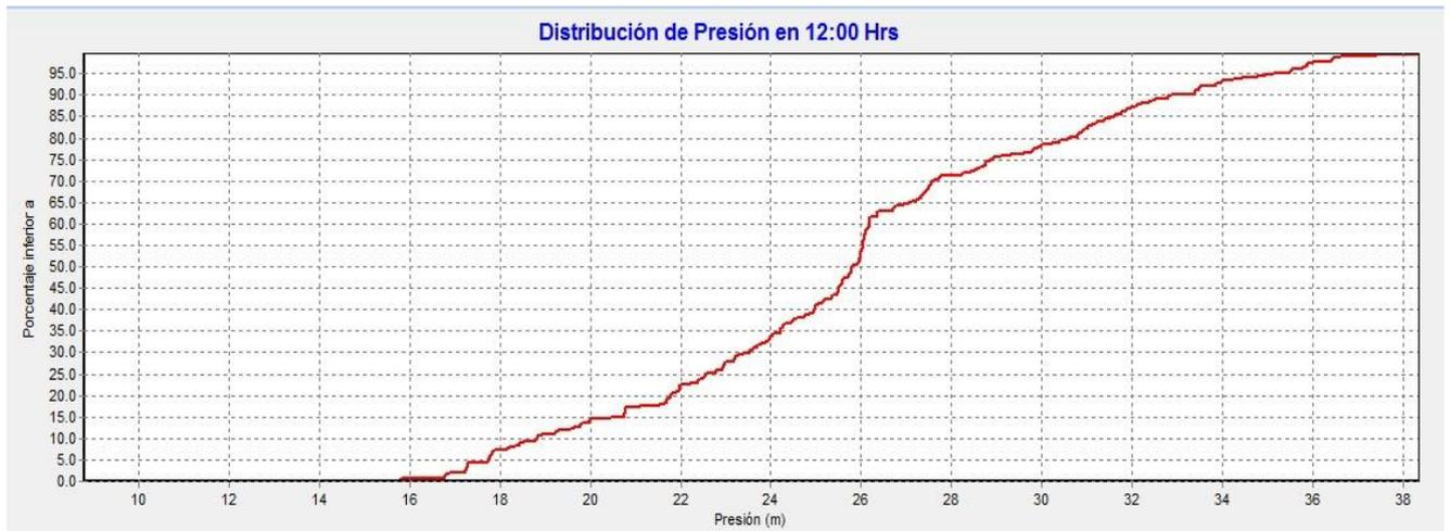
Figura 4.14. Distribución de presiones en los nodos de la red de Cholqui a las 12:00 H
