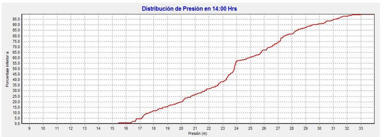
Figura 4.16. Distribución de presiones en los nodos de la red de Cholqui a las 14:00 H
