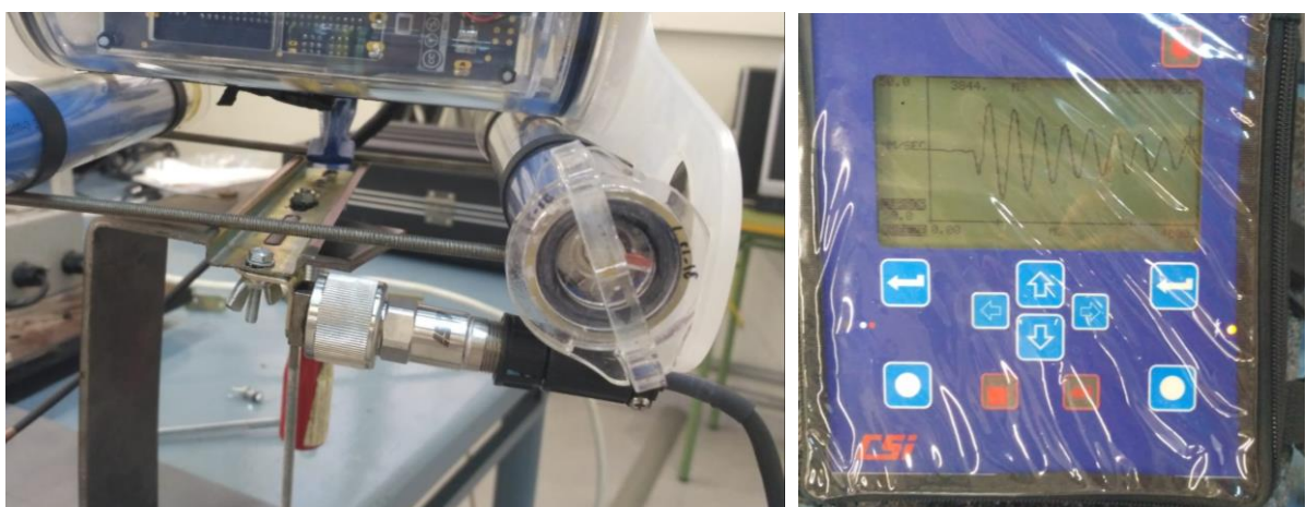
Fig. 82: Acelerómetro colocado y medida de la vibración
