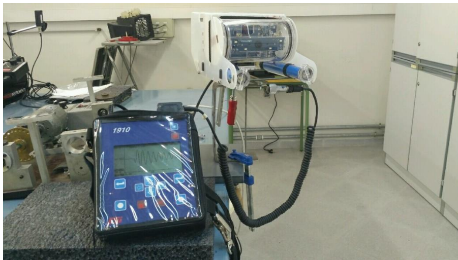
Fig. 81: Dispositivo y medidor de vibraciones
