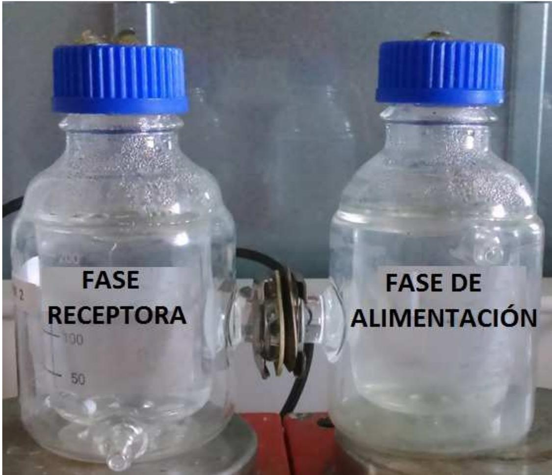
**Figura 4.2.** Fotografía de las dos cámaras utilizadas para el estudio del análisis del transporte de nutrientes en MFCs.
