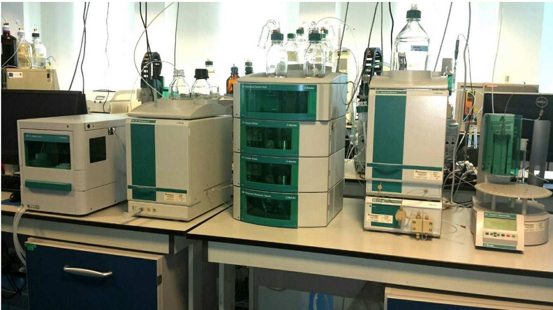
**Figura 4.7.** Cromatógrafo iónico situado en el SAIT de la Universidad Politécnica de Cartagena <sup>(158)</sup>.
