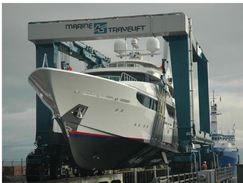
*Ilustración 13. Travelift con capacidad de carga superior a 1000 toneladas.*
