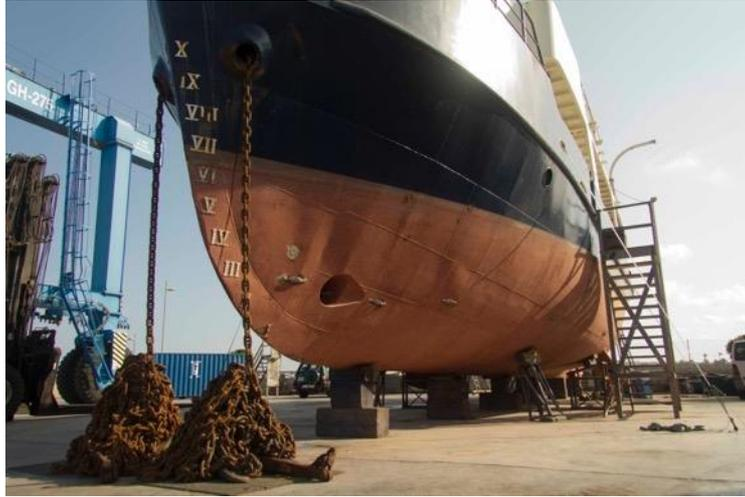
*Ilustración 26. Embarcación sobre tacos de madera.*
