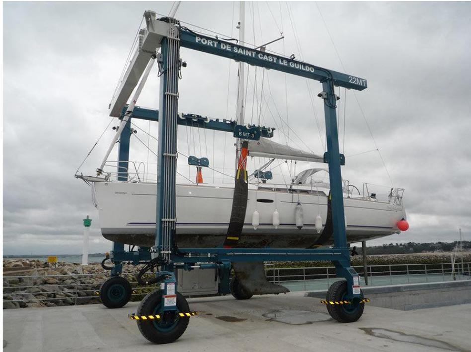
*Ilustración 24. Travelift portando una embarcación.*
