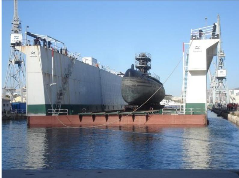
*Ilustración 10. Dique flotante.*
