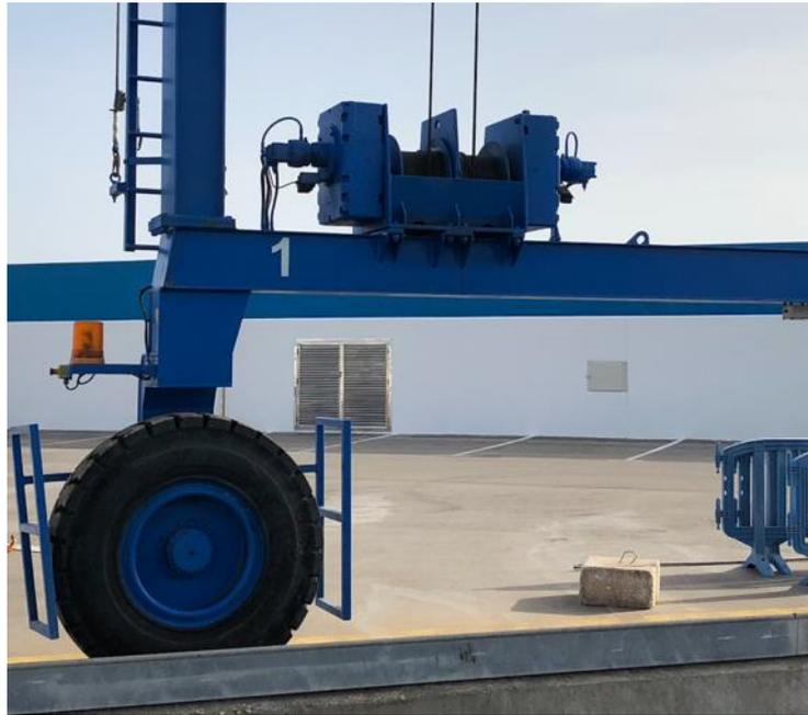
*Ilustración 19. Mecanismo de elevación. Cabrestante.*
