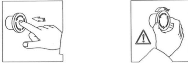
*Ilustración 52. Funcionamiento del pulsador de emergencia.*
