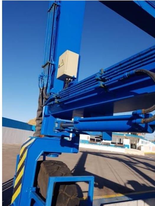
*Ilustración 15. Cilindro oleohidráulico de rotación.*
