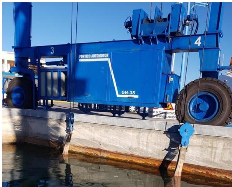
*Ilustración 46. Eslingas preparadas para varada.*
