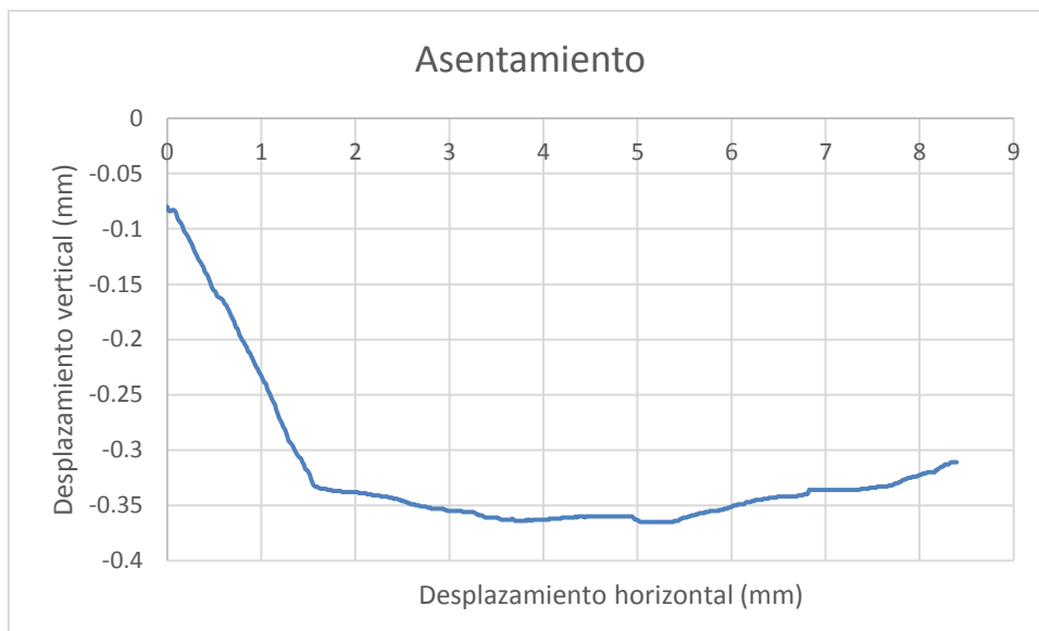
Gráfica 3.2.13 Ensayo EPS densidad 20 kg/m 3 plano irregular
