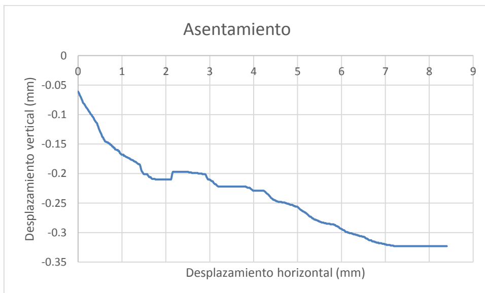
Gráfica 3.2.11 Ensayo EPS densidad 20 \text{ kg/m}^3 plano irregular
