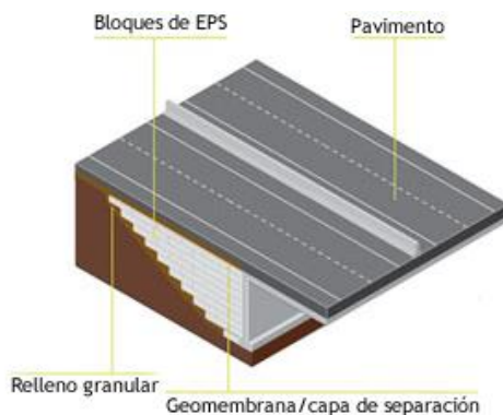
Ilustración 2.1.2.4 EPS en puentes (anape)
