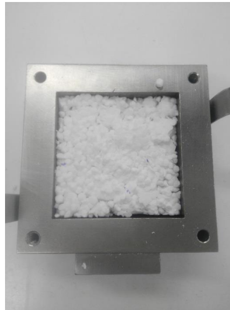
Imagen 3.12 EPS desgranado y compactado
