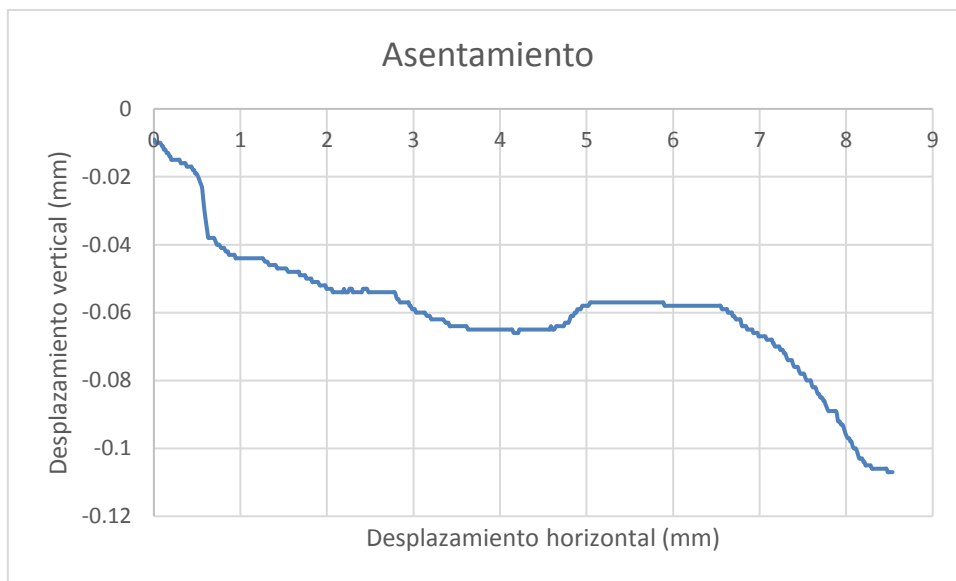
Gráfica 3.2.31 Ensayo EPS densidad 40 kg/m 3 plano nítido
