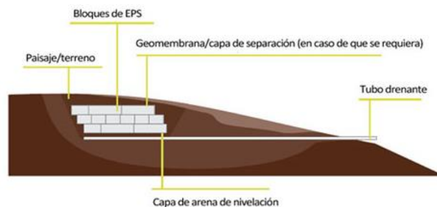
Ilustración 2.1.2.7 EPS en estabilización de taludes (anape)
