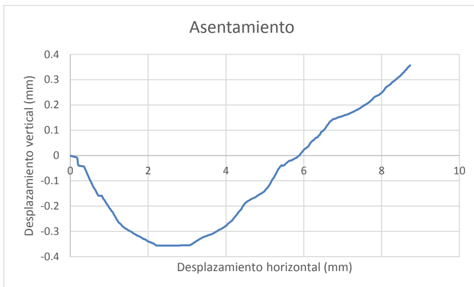
Gráfica 3.2.47 Ensayo EPS densidad 40 \text{ kg/m}^3 granulado
