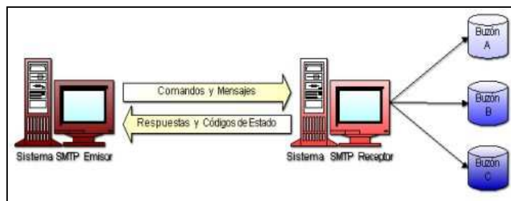
Figura 5: Modelo de comunicaciones SMTP.
