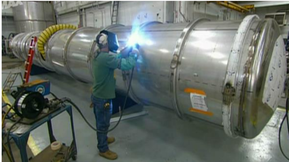
Ilustración 12 – Montaje de cisterna
