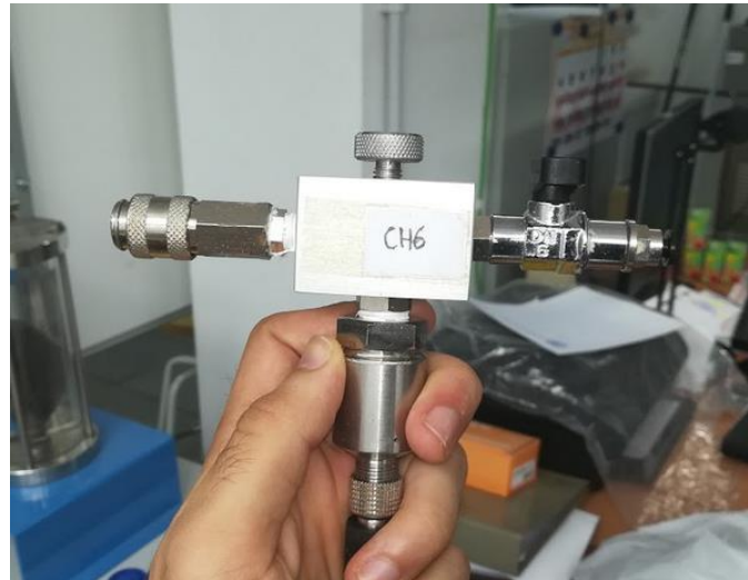
Figura 3.15 Transductor de presión intersticial CH6
