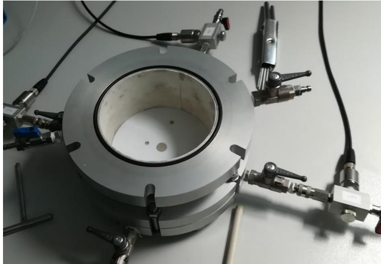
Figura 4.7 Célula Rowe con el dren perimetral colocado
