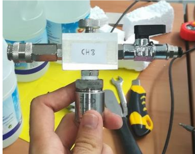
Figura 3.17 Transductor de presión intersticial CH8
