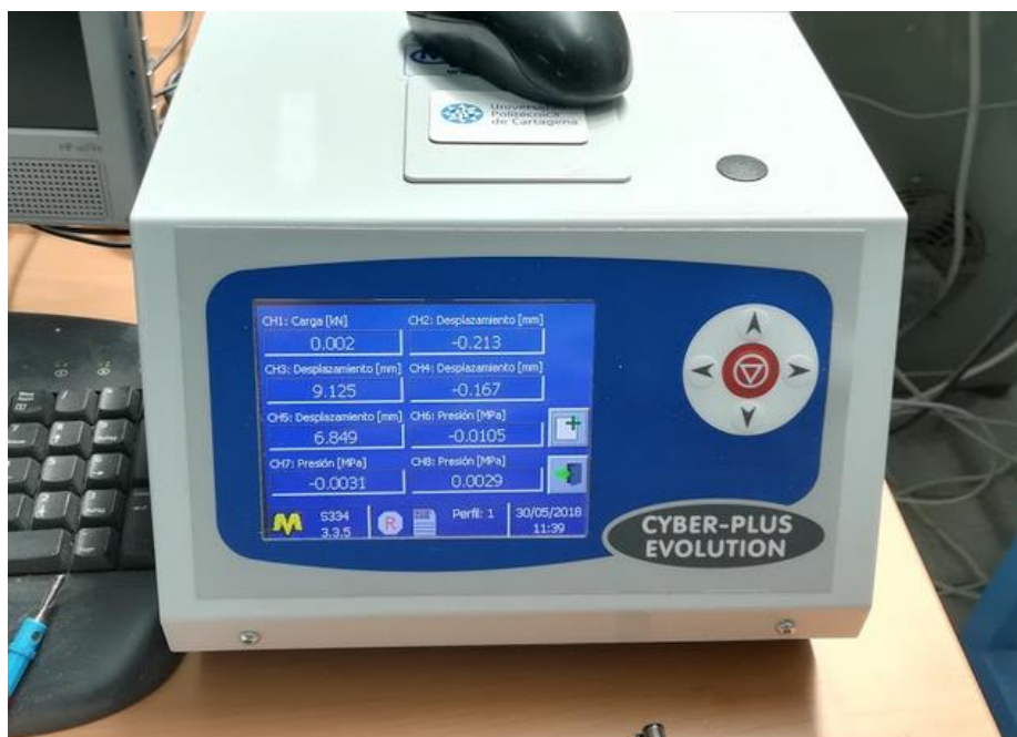
Figura 5.34 Registro de datos en módulo Cyber-Plus Evolution
