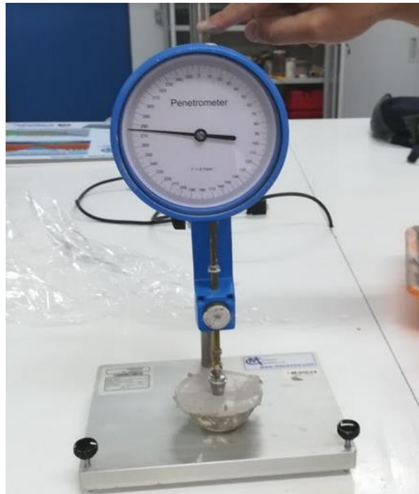
Figura 4.5 Determinación de la humedad de la muestra con el penetrómetro de cono
