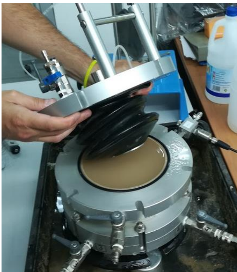
Figura 5.32 Colocación del diafragma
