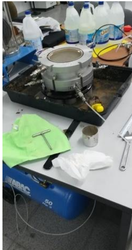
5.39 Muestra completamente saturada, antes de colocar la cubierta
