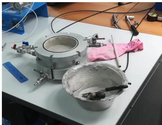
Figura 4.8 Colocación de la muestra en el interior de la célula Rowe
