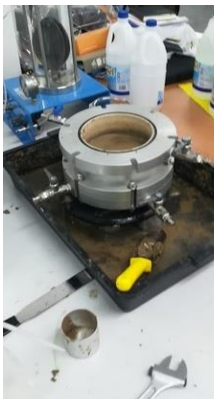
Figura 5.38 Muestra colocada en el interior de la Célula Rowe
