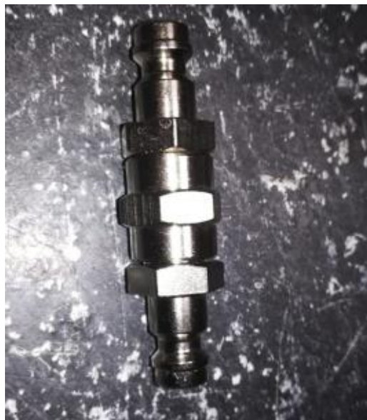
Figura 4.2 Racor macho-macho a la entrada de agua a presión al equipo
