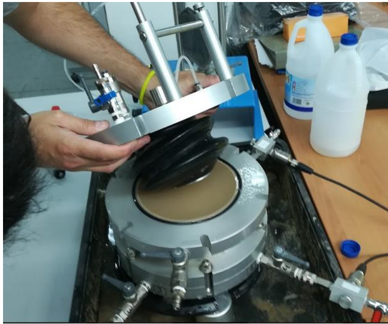
Figura 4.1 Colocación de la cubierta en la Célula Rowe
