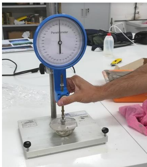
Figura 4.6 Determinación de la humedad de la muestra con el penetrómetro de cono
