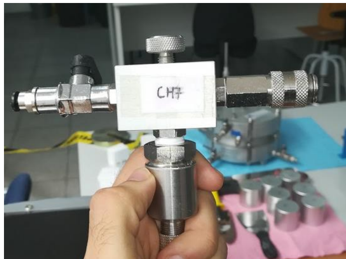
Figura 3.16 Transductor de presión intersticial CH7
