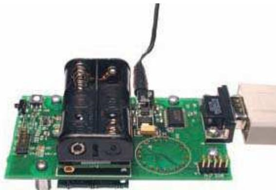
Figura 2.15. Gateway MIB510 con mote y placa sensora [11].
