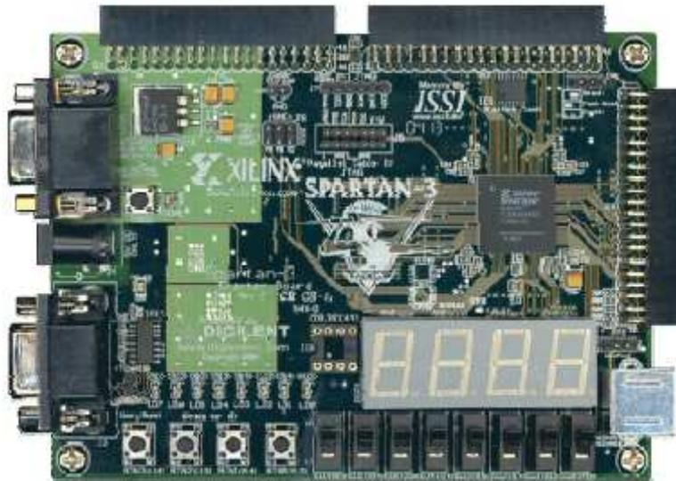
Figura 6.6. FPGA Spartan 3 integrada en placa de pruebas.
