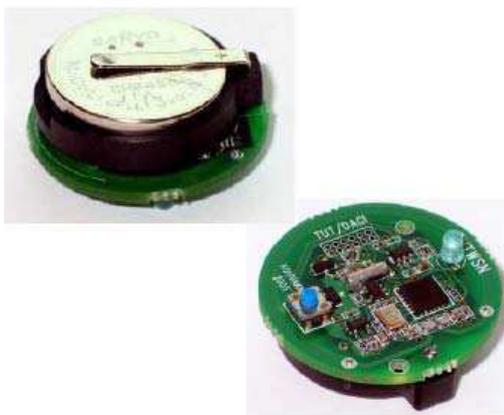
Figura 2.4. Sensor alimentado con una pila de botón [10].
