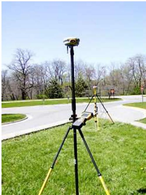
Figura 4.3. Estación y receptor GPS profesionales para precisiones centimétricas.
