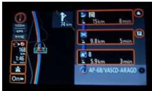
Figura 4.6. Navegador GPS de pantalla táctil de un vehículo con información sobre la ruta, así como las distancias y tiempos de llegada al punto de destino.
