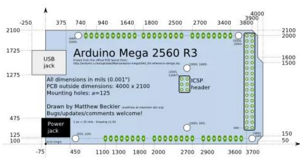
Ilustración 12. Dimensiones de Arduino MEGA
