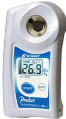
Fotografía 36: Medición de los SST con un refractómetro digital Atago.
