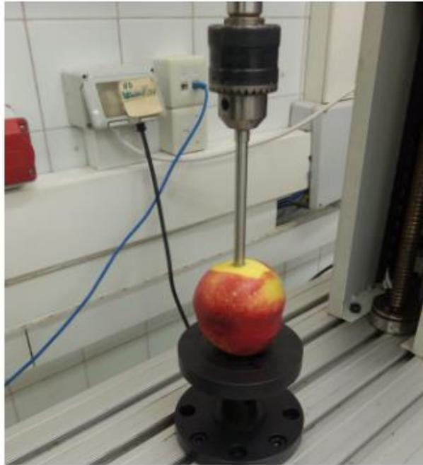
Fotografía 35. Medida de firmeza con una prensa universal o texturómetro.
