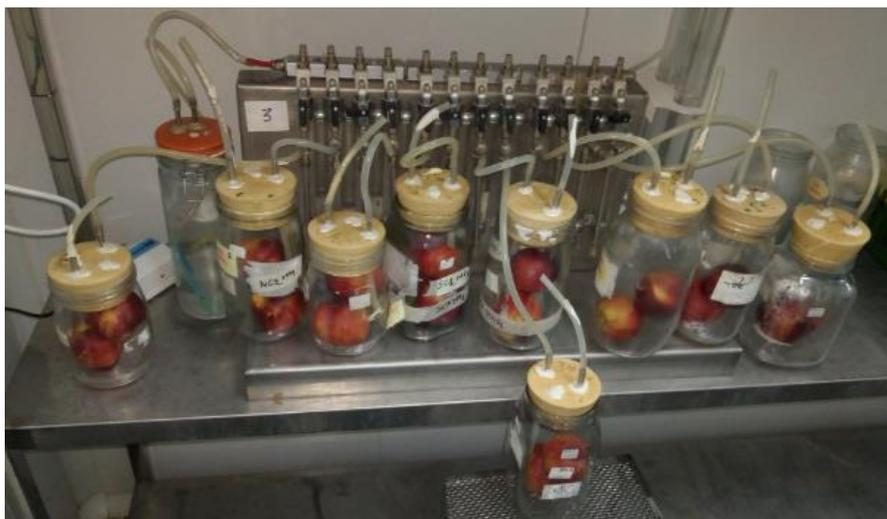
Fotografía 40. Montaje para la determinación de la actividad respiratoria y de la emisión de etileno
