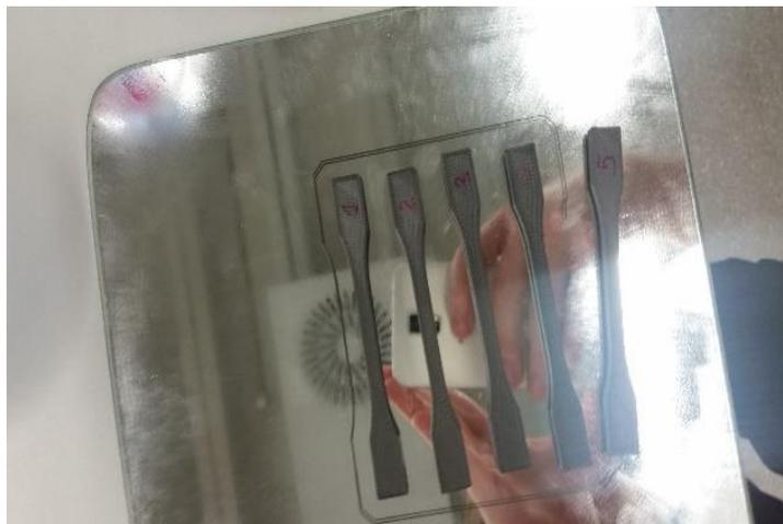
Por razones que se explican en el punto 3.5, se han vuelto a imprimir las probetas del 20% para 45°, 68° y 90°. Antes de esto la impresora PrusaLemon fue reparada. Se volvieron a fabricar en el taller las piezas del “nozzle” y el “barrel” por estar muy dañadas. Las impresiones han salido todas bien. Lo único destacable es que sigue faltando la esquina de la última probeta en estas series.
