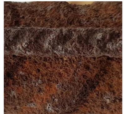
Figura 10 Barra afectada por corrosión
