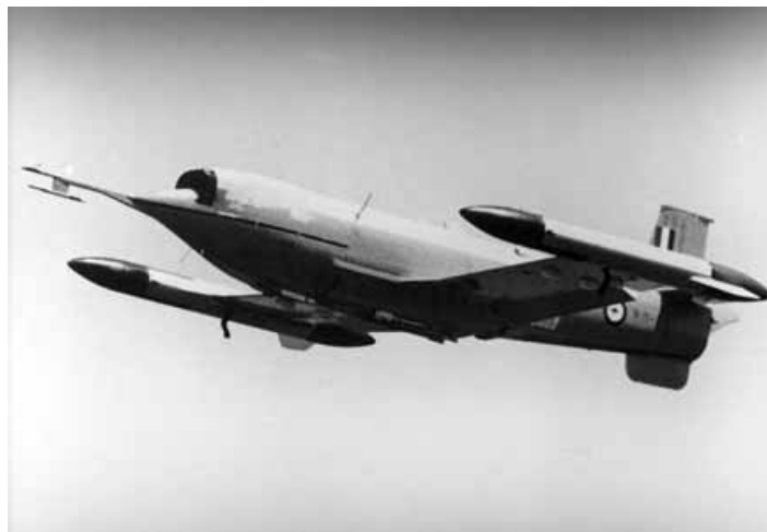
Figura 1.1: UAV GAF Jindivik controlado remotamente por radiofrecuencia.
