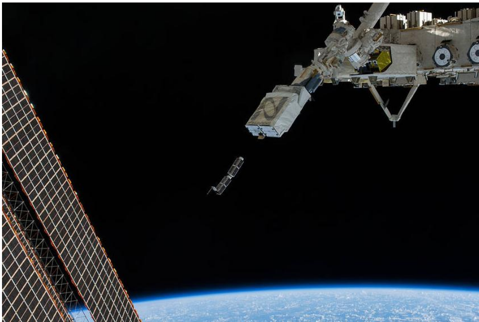
Figura 1: Despliegue de un conjunto de CubeSats (NASA, 2017)
