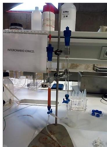
Imagen 16. Columnas de cromatografía líquida Luer Lock
