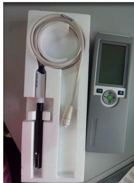
**Imagen 13. Conductivímetro Metter Toledo Seven2Go**
