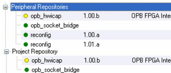
Se puede observar que en el apartado *Peripheral Repositories* se muestran todos los elementos, tanto los periféricos del repositorio (*reconfig*) como los añadidos a la carpeta *pcores* del proyecto (*opb\_socket\_brigde* y *opb\_hwicap*).
