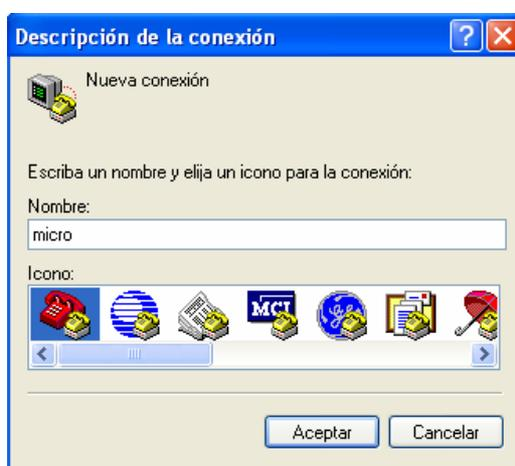
Esta conexión se configura siguiendo los parámetros indicados a la *UART* en el *wizard* del *EDK* (Ver Anexo 2), en este caso 115000 bps, 8 bits de datos sin paridad, 1 bit de parada y sin control de flujo. Finalmente se hace clic en aceptar, de tal manera que comienza la conexión.
