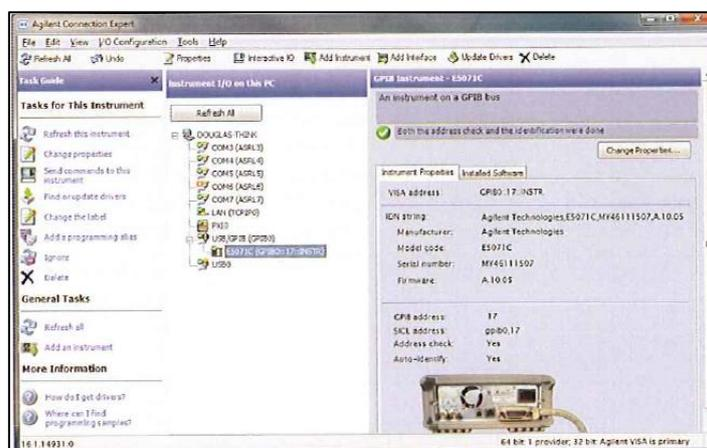
Figura 11. Comunicación entre VNA y PC via USB-to-GPIB, con *Agilent IO Libraries Suite*
