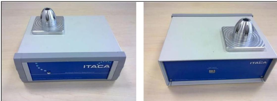
Figura 13. Dielectrómetro
