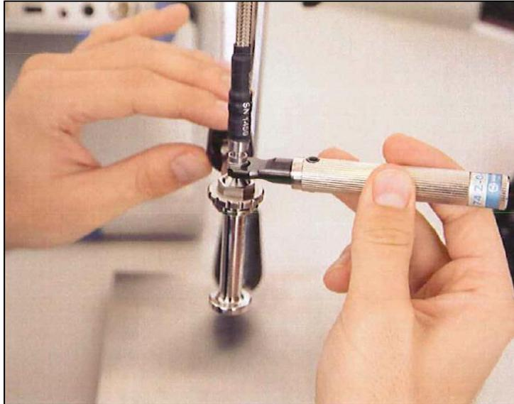
Figura 8(b). Conexión del cable con la sonda
