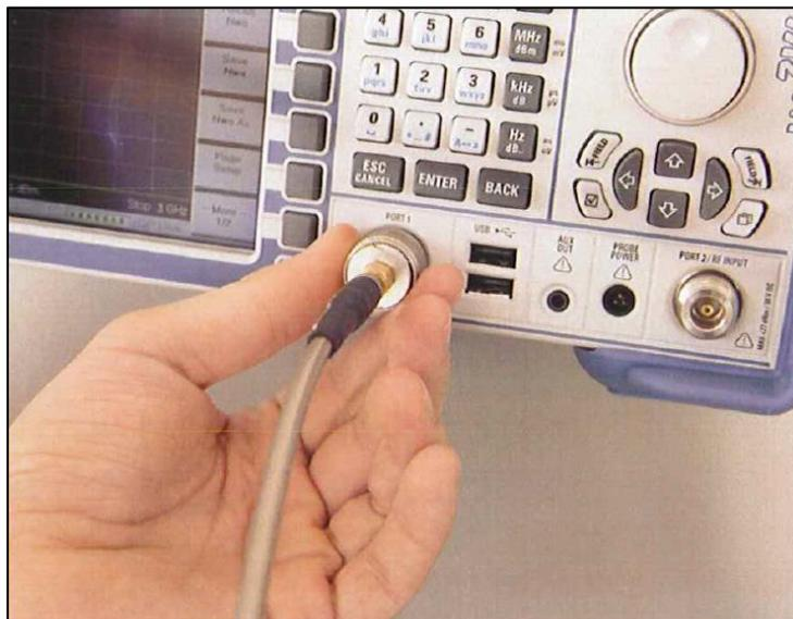
Figura 8(a). Conexión del cable con el VNA
