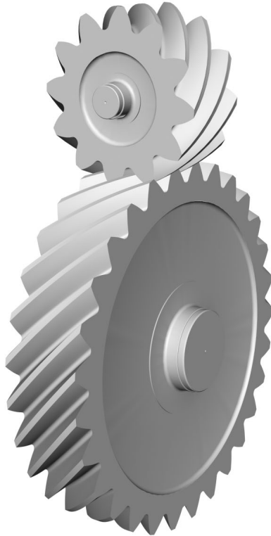
Figura 3.1.1: Transmisión de engranajes helicoidales con ejes cruzados.
