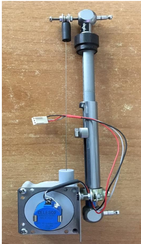
Figura 5.50 Detalle de integración potenciómetro hilo
