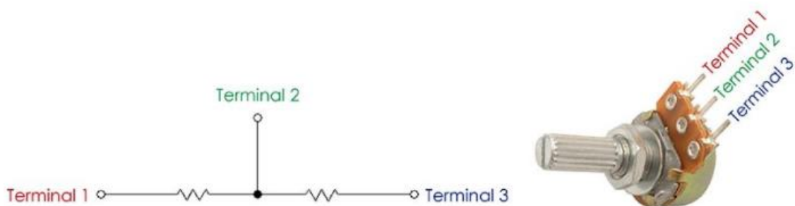
Figura 5.1 Estructura de un potenciómetro
