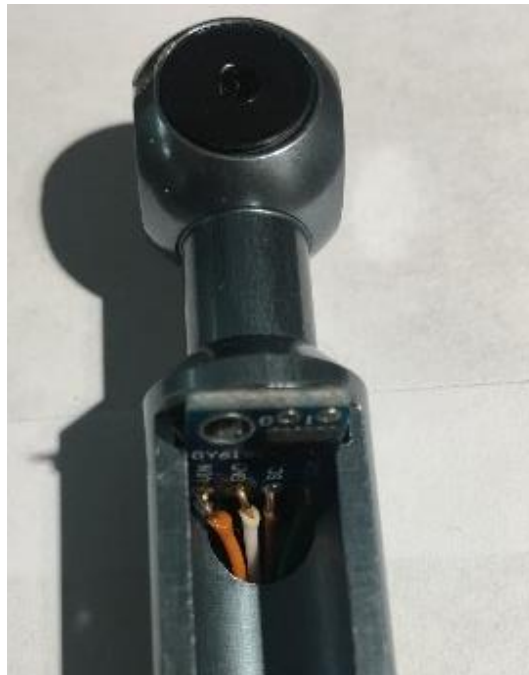
Figura 5.18 Integración sensor Adafruit VL6180X en actuador mecánico
