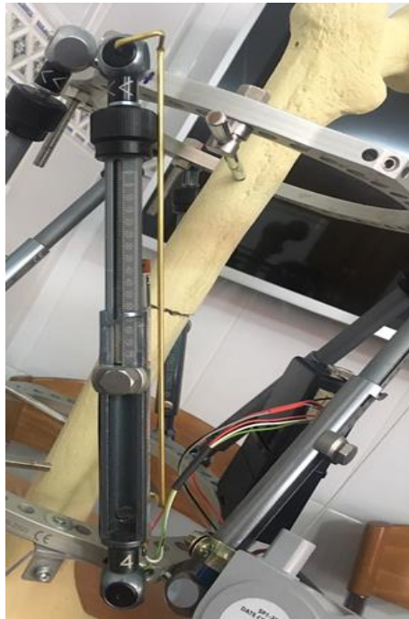
Figura 5.45 Segunda perspectiva integración potenciómetro deslizante en el TL-Hex
