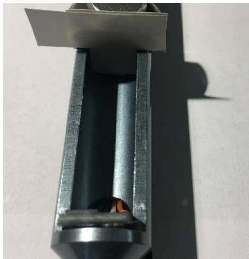
Figura 5.19 Pantalla reflectora de sensor Adafruit VL6180X
