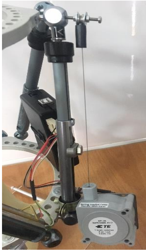
Figura 5.49 Integración potenciómetro hilo en el TL-Hex
