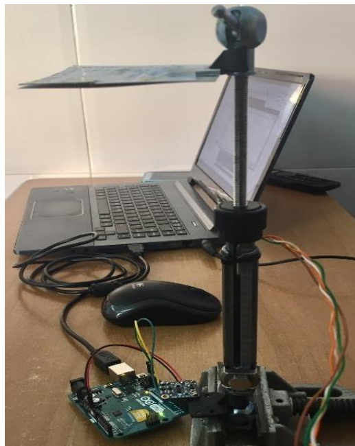
Figura 5.16 Integración plataformas y sensor Adafruit VL53L0X
