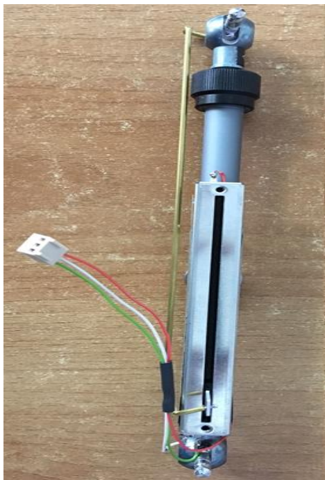
Figura 5.46 Vista posterior de integración potenciómetro deslizante
