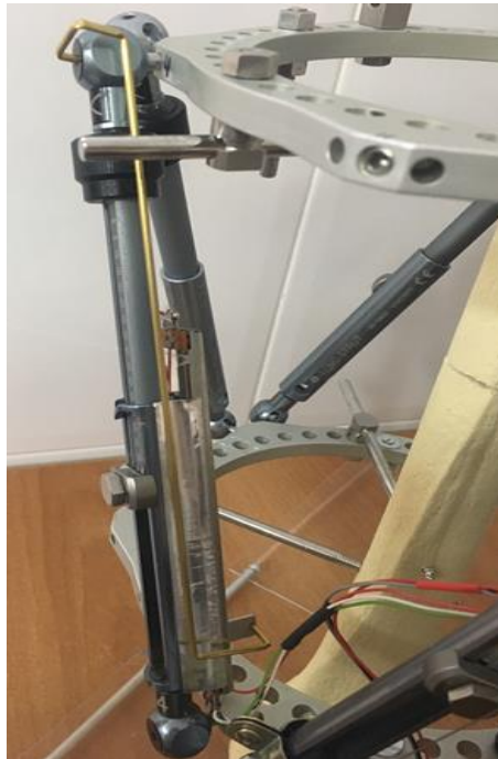
Figura 5.44 Primera perspectiva integración potenciómetro deslizante en el TL-Hex
