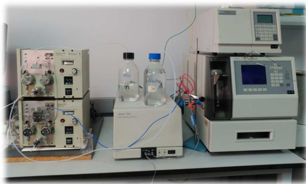
Figura 13: Cromatógrafo HPLC modular Water. Bombas de alta presión a la izquierda de la imagen.
