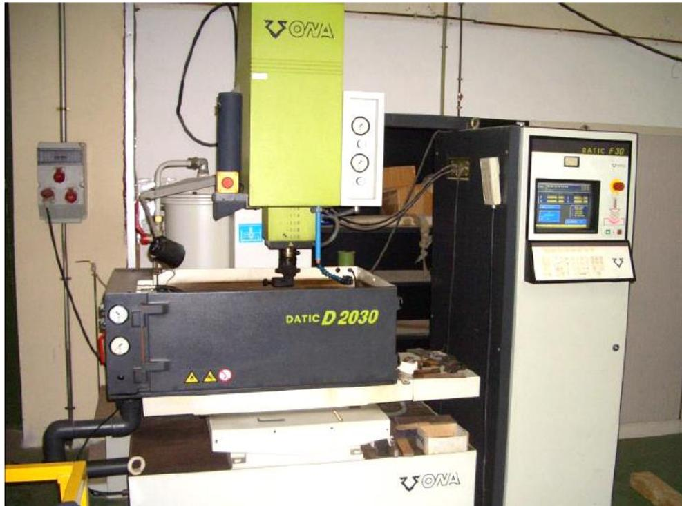
Figura 2.1 Máquina de electroerosión ONA DATIC D2030.
