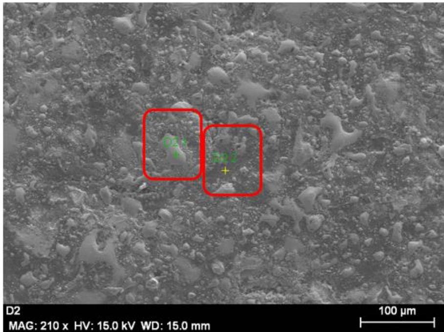
Figura 3.48 Ejemplo de selección de protuberancia y depresión en la superficie del electrodo para una intensidad de corriente de 8 A y profundidad de penetración de 7 mm.
