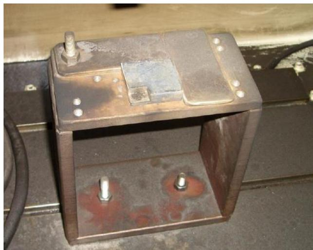
Figura 2.7 Utillaje para la fijación de las piezas.
