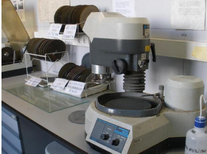
Figura 3.5 Pulidora metalográfica para la preparación de los electrodos.
