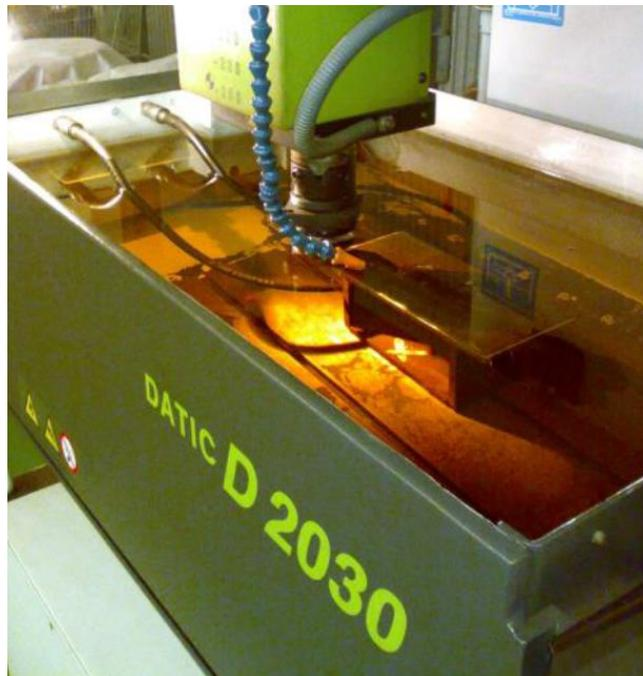
Figura 2.6 Tanque de la máquina de electroerosión ONA DATIC D 2030.
