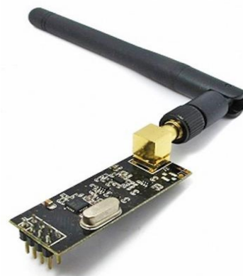
Ilustración 25:Antena amplificadora NRF24L01
