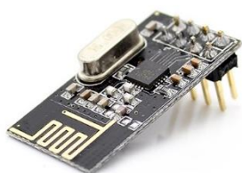
Ilustración 24: Transceptor NRF 24L01 / Pin-out del NRF24L01
