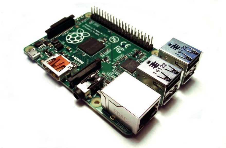
Ilustración 23:Raspberry Pi modelo B+
