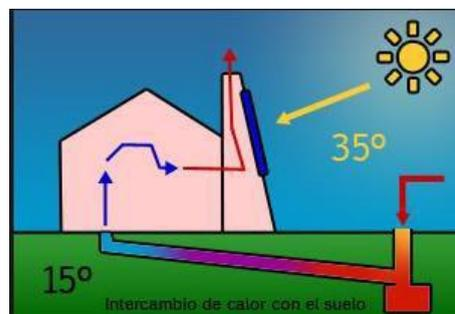
*Ilustración 14. Esquema de funcionamiento de una chimenea solar (Andrea, 2013)*
