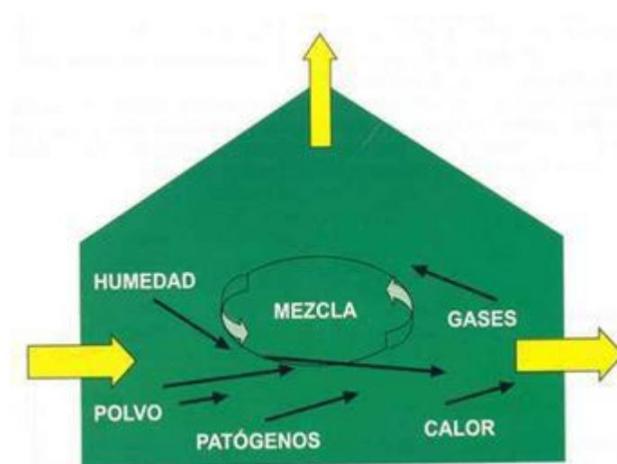
Ilustración 10. Esquema de funcionamiento de la ventilación ((MIT), 2001).
