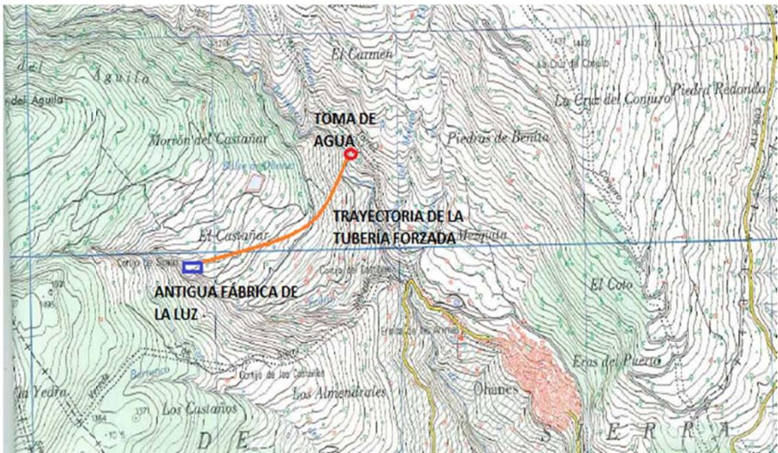
Figura 3.1: Ubicación de la antigua fábrica de la luz y recorrido de la tubería forzada. Fuente: Elaboración propia.
