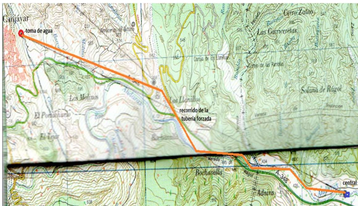
Figura 3.6: Tercera alternativa para la ubicación de la Central y trazado de la tubería forzada. Fuente: Elaboración propia.
