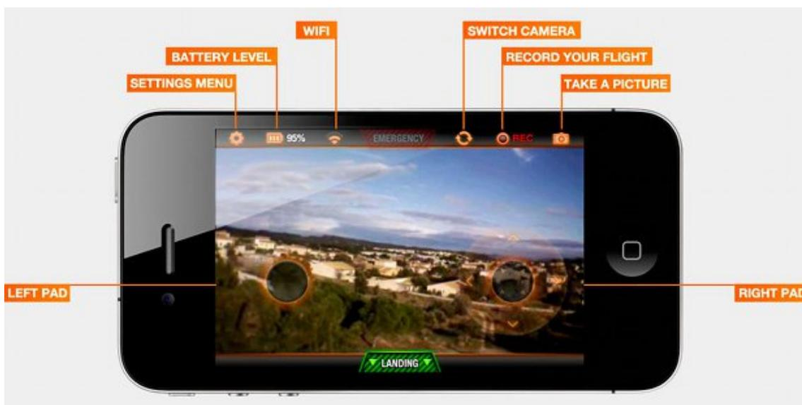
Figura 2.16. Pantalla de Control de la aplicación AR.Freeflight.
