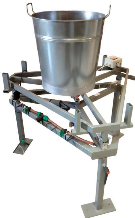
**Ilustración 2 - Lisímetro utilizado en el diseño**
