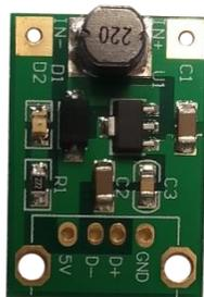
Ilustración 38 - Convertidor DC-DC 5V (DealExtreme, 2016)
