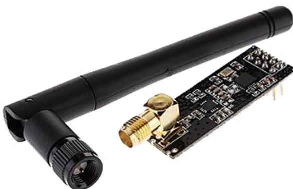
Ilustración 19 - nRF24L01+ con antena
