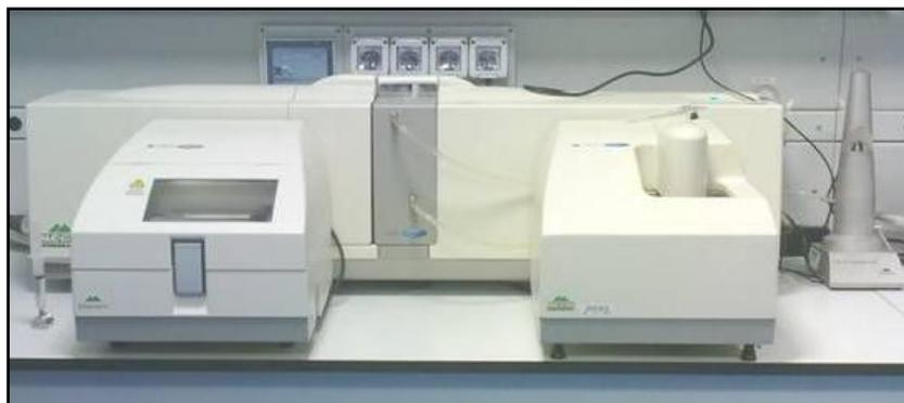
*Figura 20. Analizador Malvern Instruments Mastersizer 2000LF*
