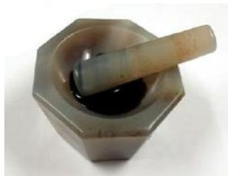
*Figura 25. Dispersión de CNTs en el líquido iónico mediante molienda mecánica.*
