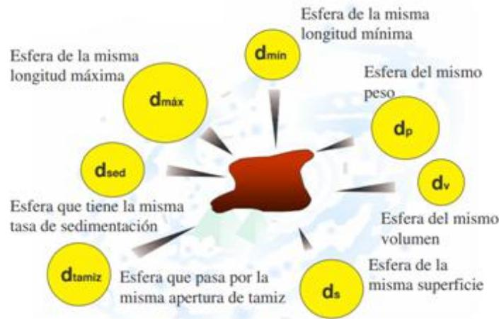
Figura 11. Diferentes diámetros medidos en función de la técnica empleada. Figura extraída de [25].
