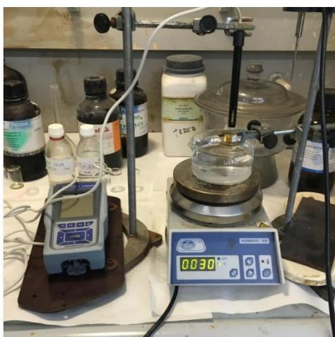
Figura 28. Montaje para la medida de las conductividades a 30 °C.
