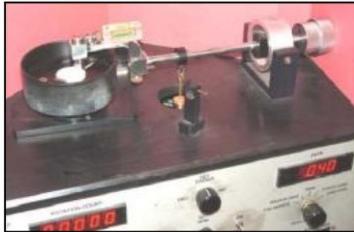
Figura 23. Tribómetro ISC-200. Figura extraída de [31].
