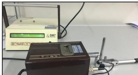
*Figura 18. Rugosímetro Profiltest SM-7*
