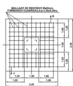
PLANTA MALLA EQUIPOTENCIAL
