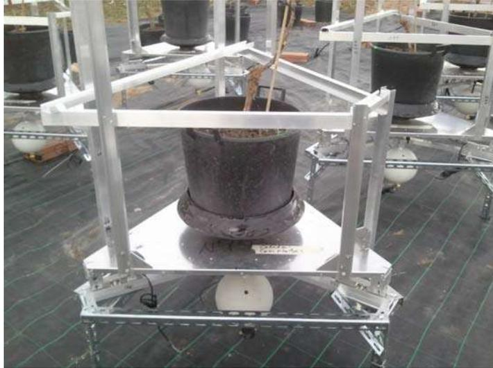
Figura 2.2: lisímetro de pesada
