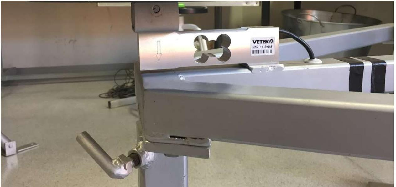
Figura 2.8: célula de carga posicionada en la estructura de lisímetro
