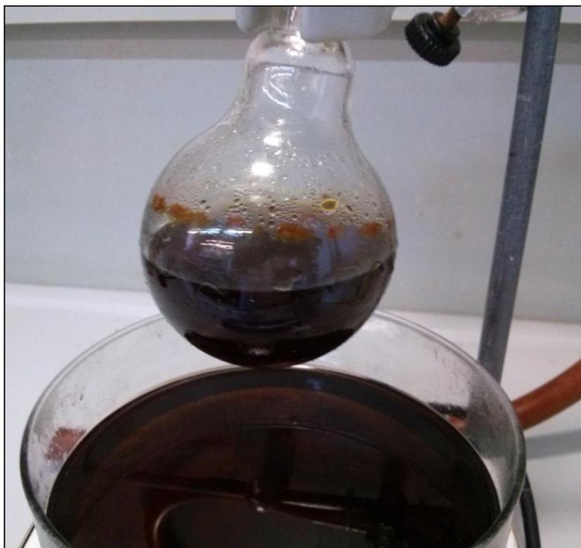
**Foto 1. Mezcla Ácido Acético, Pd(AcO)<sub>2</sub> y base de [N(4-Metoxibenciliden)-(P-sulfonato anilina)] en baño de Aceite a 250-300°C**
