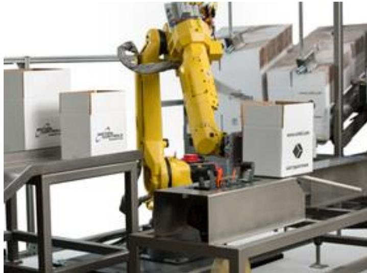
**Fig. 3 Robot formador de cajas**
