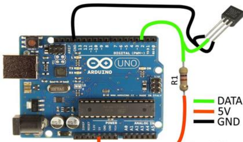
Figura 2.10- Conexión del sensor DS18B20 al microcontrolador Arduino
