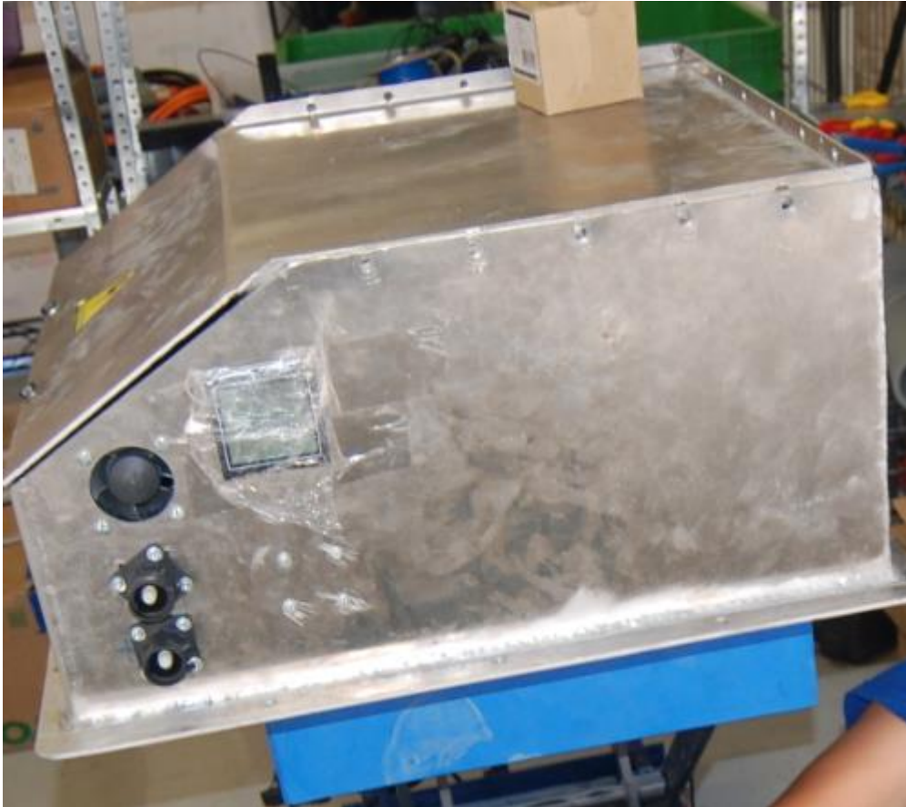
Fig. Caja contenedora de todos los módulos de baterías
