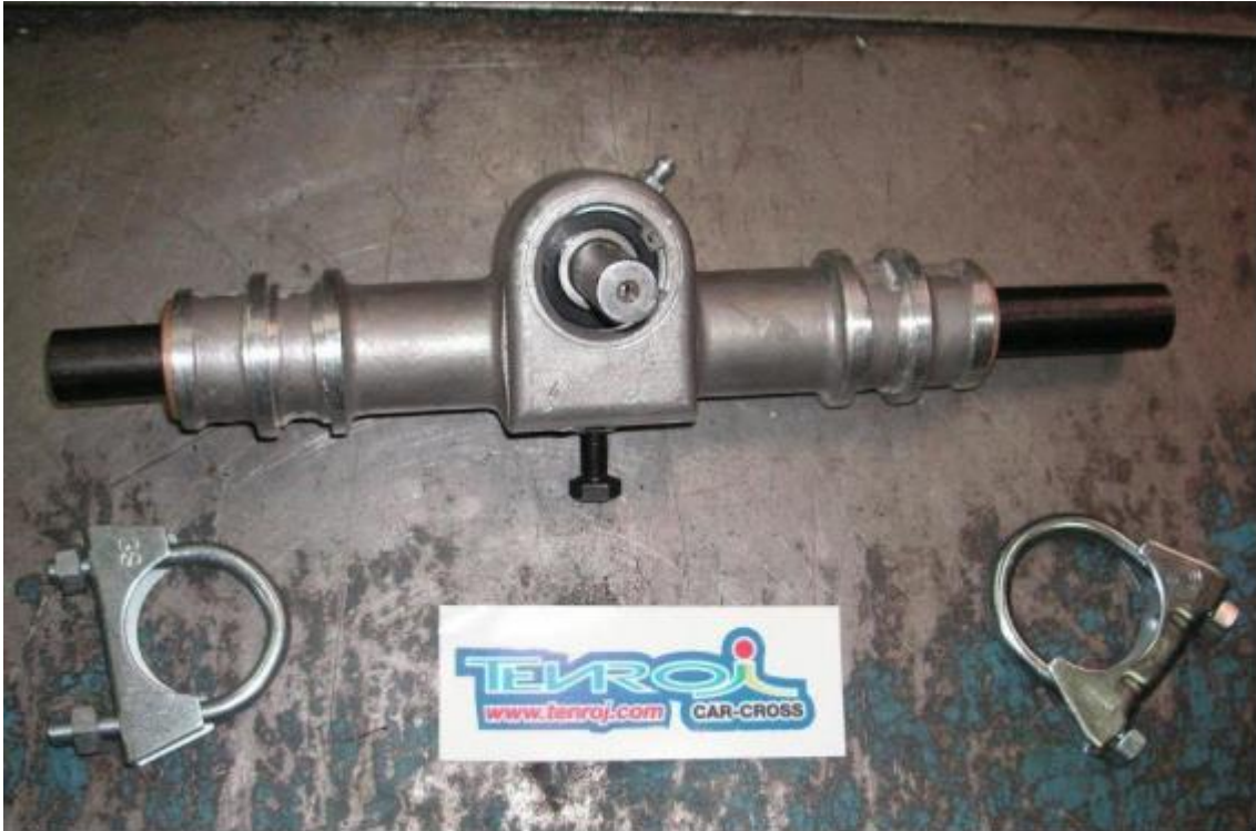
Fig. Cremallera de tenroj, utilizada en el sistema
