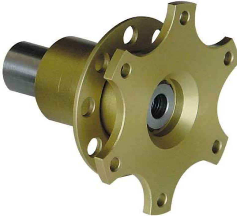
Fig .Elemento de desconexión rápida del volante.
