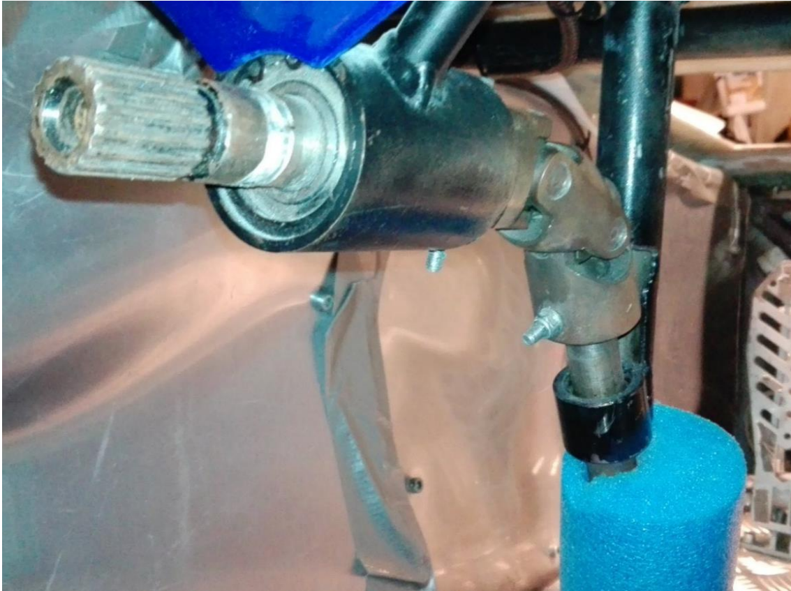
Fig. Montaje del quick release, junta cardan y columna del sistema de dirección.
