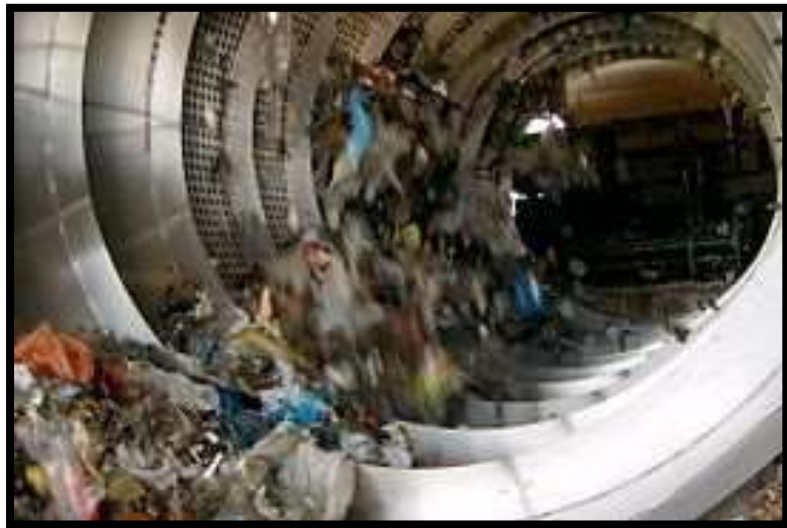
Fig. 16 Tromel mallado para separación granulométrica
