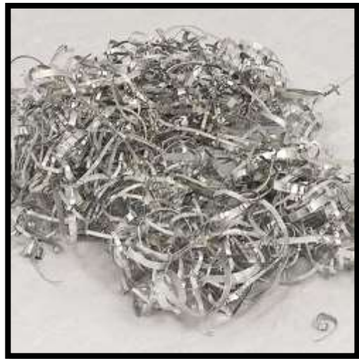
Fig.28 Viruta de aluminio producida en un torno de mecanizado.
