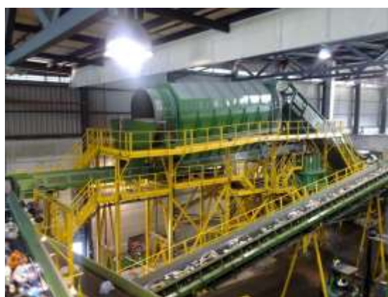
Fig.14 Planta de selección de residuos, con tambor giratorio en el centro.
