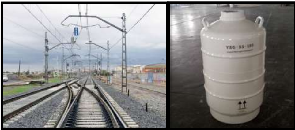
Fig.22 Catenarias eléctricas y bidón fabricados con aluminio
