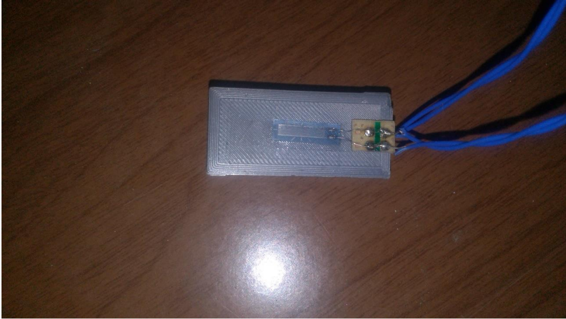
Figura 7.4. Situación de la galga del sensor de cuarto de puente
