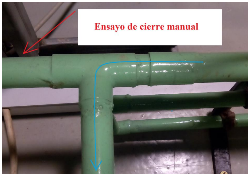
Figura 4.6. Te de diámetro exterior de 22 mm en flujo lateral
