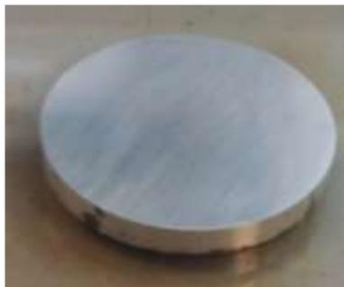
*Ilustración 31. Probeta de aluminio 7075*
