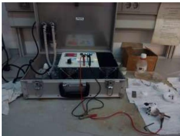
*Ilustración 34. Conexión de la celda electrolítica a la fuente de tensión*
