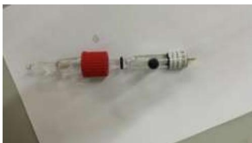
*Ilustración 22. Electrodo de referencia Ag/AgCl 3,5 M*
