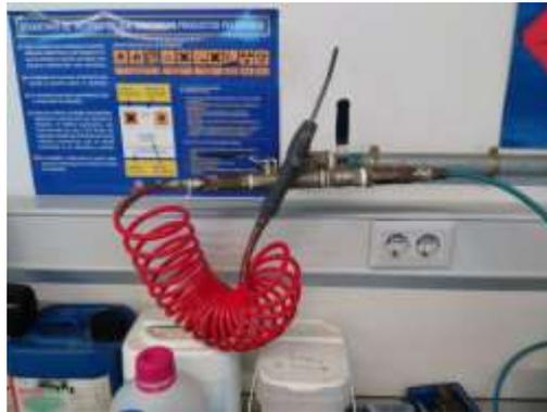
*Ilustración 15. Pistola de aire comprimido*
