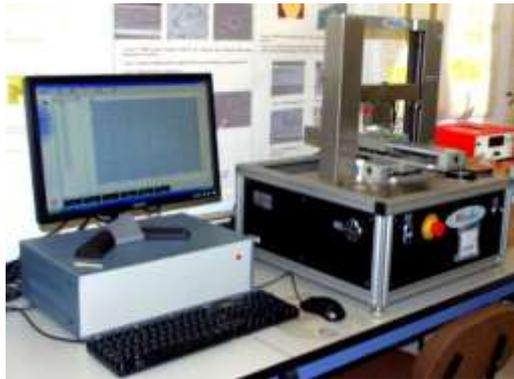
*Ilustración 25. Scratch Tester.*
