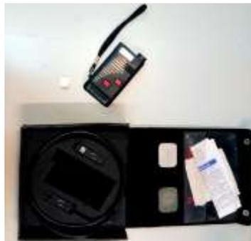
*Ilustración 29. Medidor de espesor de revestimiento QNix 7500*
