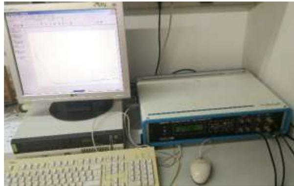
*Ilustración 23. Potenciostato PGP 201.*
