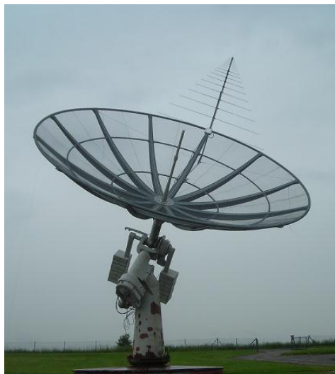
Figura 1.13. Parabólica de 6m y LPDA fijada al borde del disco.
