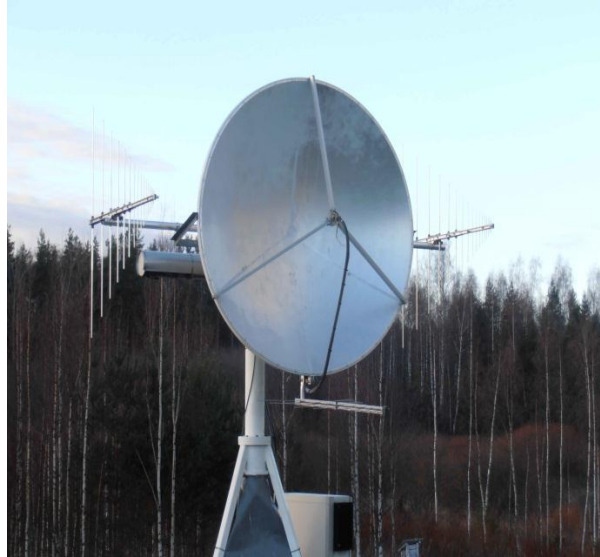
Figura 1.14. Parabólica de 1.8 m y tres LPDA adheridas a su estructura.
