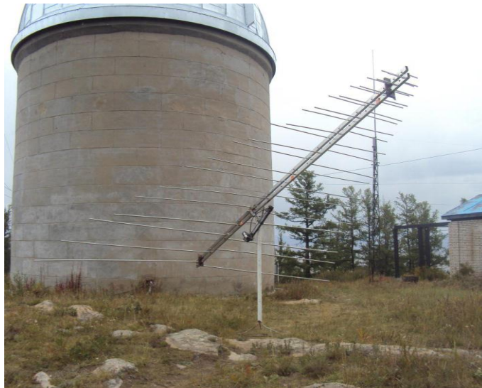
Figura 1.17. LDPA polarización lineal sin seguimiento del Sol
