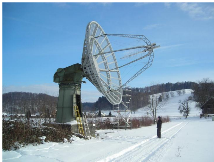
Figura 1.11. Parabólica de 7m de diámetro con LPDA de doble polarización en su foco.
