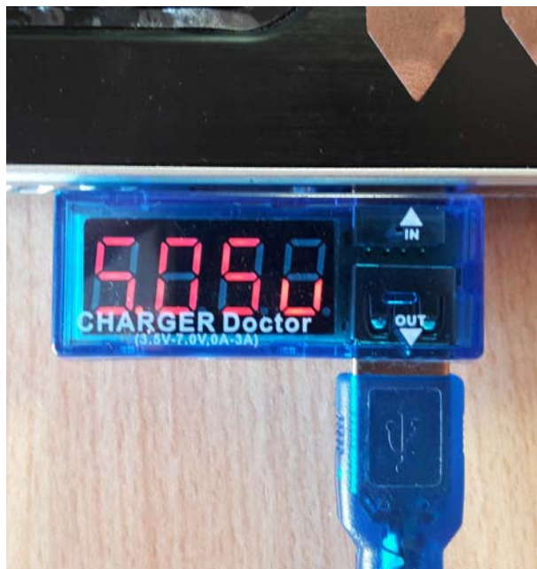
Figura 38. Test de voltaje.
