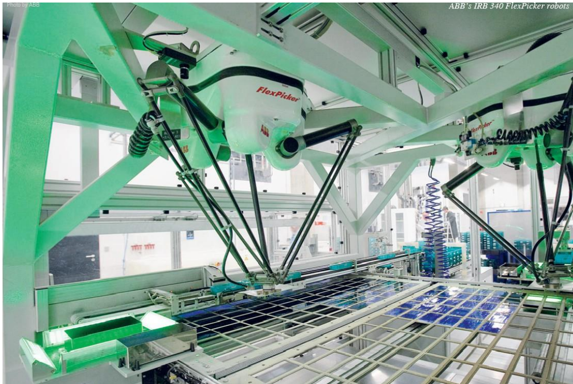
5.-Robot Delta de ABB, de cinemática paralela
