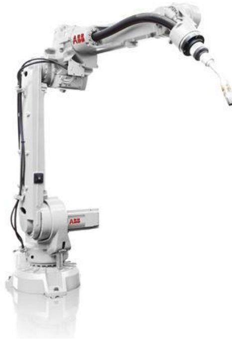
52.-Robot de soldadura IRB-2600ID para la línea de carrocería
