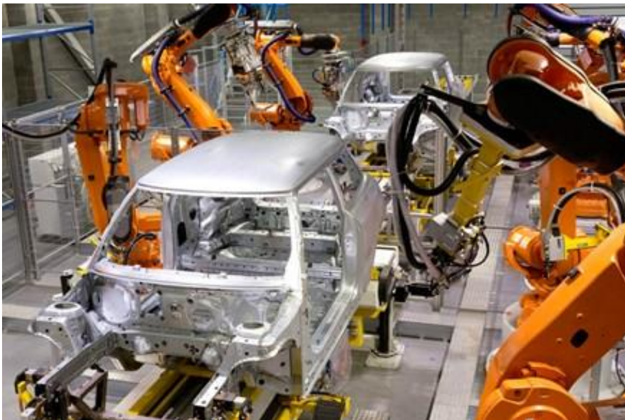
26.-Soldadura de carrocerías BIW (Body in white)
