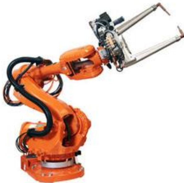
15.-Robot de soldadura por resistencia
