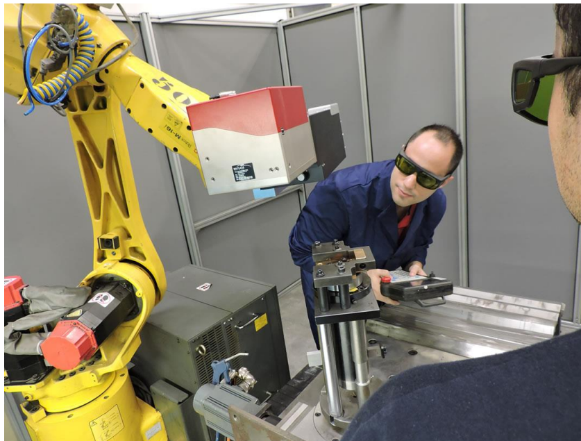
25.-Cabezal láser acoplado a robot de soldadura
