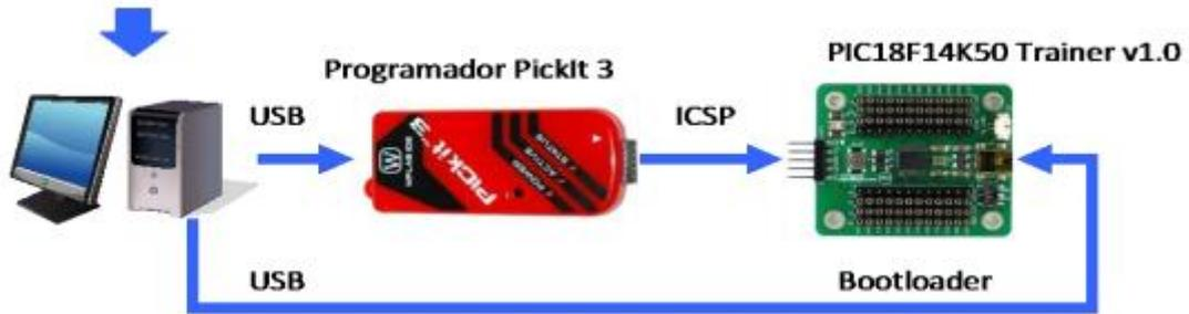
Figura 13.- Esquema de conexión del entorno de desarrollo software.
