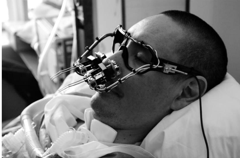
Figura 7.- Dispositivo con tecnología EyeWriter implementada.
