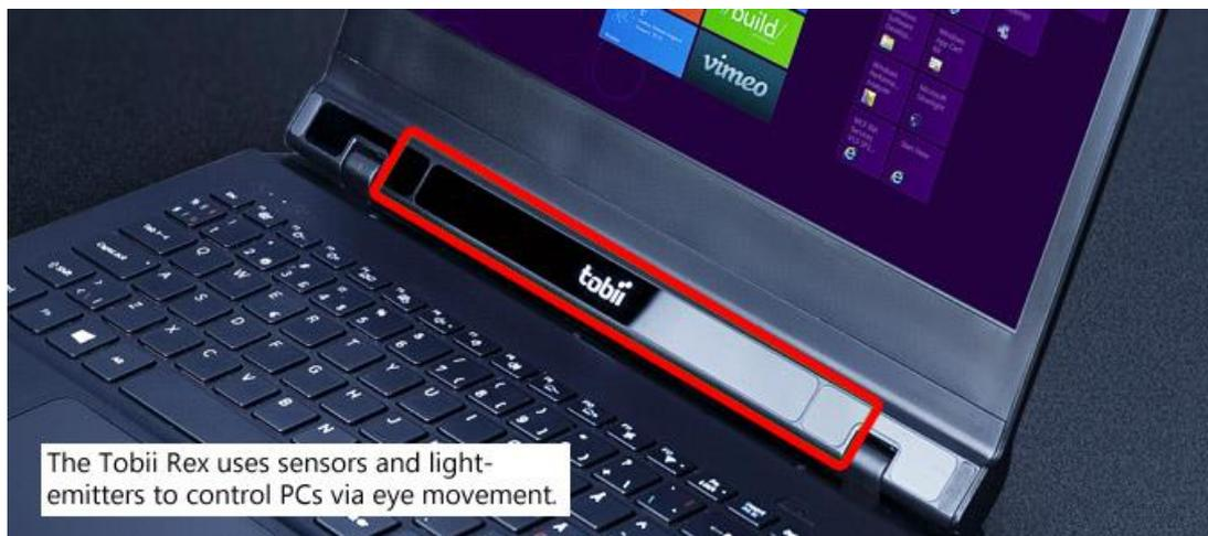
Figura 10.- Dispositivo Tobii [Laptopmag].
