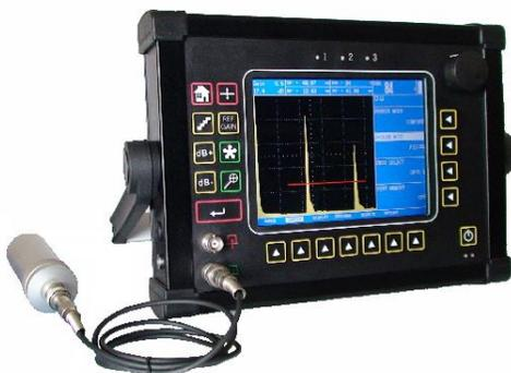
**Figura 11.8-1: Portable detector de defectos por ultrasonidos**
