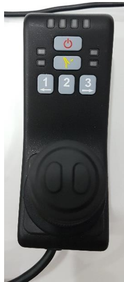
Figura 4.8 Joystick del Mico 2
